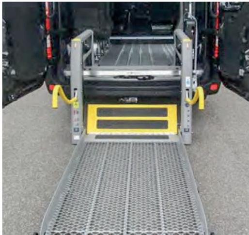
Der elektrohydraulische Linearlift kann auch schwere Elektrorollstühle problemlos heben. Die maximale Traglast = 400 kg.
