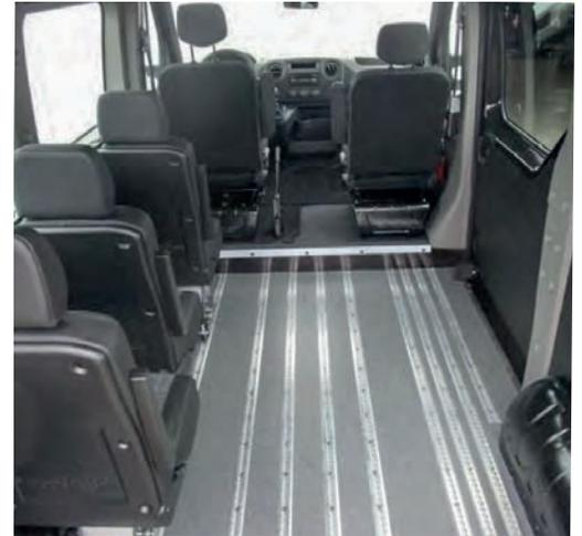
Dank der Alu-Rasterschienen des Smart Floor Bodens können auch Sicherungssysteme, wie beispielsweise Retraktoren, an jeder Position sicher fixiert werden.
