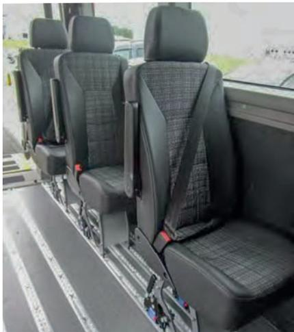
Die Einzelsitze mit integriertem Dreipunkt-Sicherheitsgurt können individuell je nach Bedarf im Fahrzeug platziert werden.
